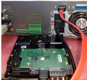
Fig. B-2 Conexión de un disco duro normal
